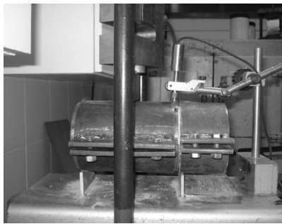
Figura 11: Determinación de adherencia LCB sobre testigos.
