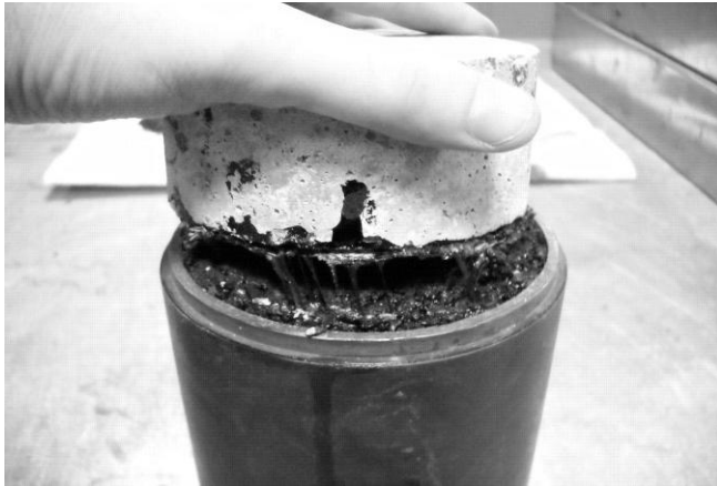
Figura 2: Probeta con Geocompuesto al finalizar el ensayo de adherencia LCB
